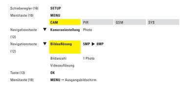
Durch Drücken der Navigationstasten (12) ▶ oder ◀ wählen Sie 8MP, 12MP oder 3MP aus.
