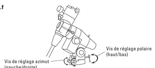
Vis de réglage azimut (gauche/droite) Vis de réglage polaire (haut/bas)
