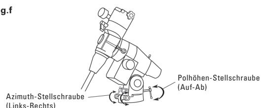
Azimuth-Stellschraube (Links-Rechts) Polhöhen-Stellschraube (Auf-Ab)
