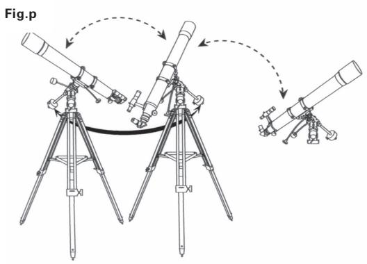
Exemples de mouvements autour des axes R.A. et DEC.
