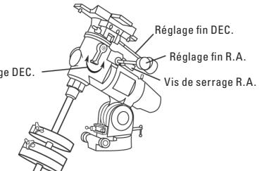
Vis de serrage DEC. Réglage fin DEC. Réglage fin R.A. Vis de serrage R.A.
