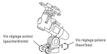
Vis réglage azimut (gauche/droite) Vis réglage polaire (haut/bas)
