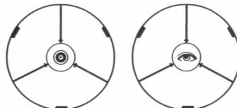
Ambos espejos alineados con la tapa de colimación colocada
