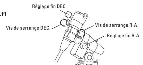
Vis de serrage DEC. Vis de serrage R.A. Réglage fin DEC. Réglage fin R.A.
