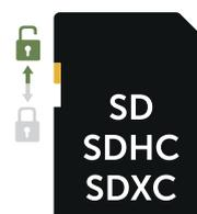
Inserte una tarjeta de memoria SD/SDHC/SDXC (no incluida) con el **lado rotulado hacia arriba** en la ranura para la tarjeta SD (16), hasta que encaje completamente. Para formatear la tarjeta SD con la cámara de vigilancia, consulte el **capítulo 08.3**.
