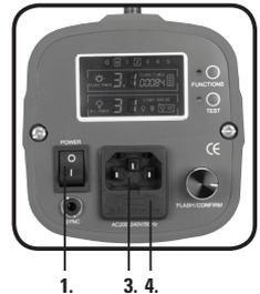
Замените предохранитель. Задвиньте держатель предохранителя в отсек для предохранителя (4) так, чтобы он закрылся, и вы услышали щелчок. Если ЖК-Дисплей все-таки не загорается, обратитесь к представителю компании DÖRR в вашем регионе, или пишите по адресу [export@doerrfoto.de](mailto:export@doerrfoto.de). Запасные предохранители входят в комплект (см. рис.).
